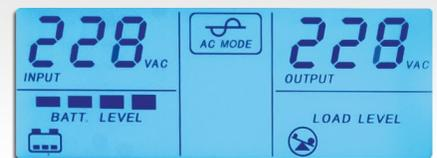
Die umfassende LCD-Anzeige für einfaches Auslesen des USV-Status am Bildschirm, wie zum Beispiel Leistungseingang, Spannung, Ladezustand, Batteriestand, ...
