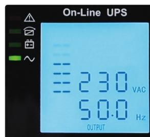
Die übersichtliche grafische Darstellung ermöglicht ein einfaches Auslesen der USV am Bildschirm, wie z.B. Spannung, Belastung, Batterie-Ladezustand, Fehlercode, etc.
